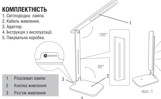
У складеному стані, за умови увімкнення на мінімальному рівні потужності, особливості конструкції лампи дозволяють використовувати її у якості нічного світильника, світло від якого розсіяно і спрямовано у зворотній від очей бік.(мал.1)
